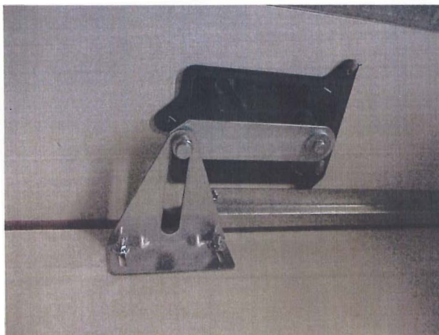
Bras de guidage [24], patte de transmission [19] et cadre de renfort [13].
